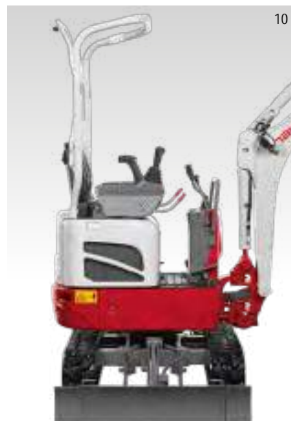
PORTE-À-FAUX DE SEULEMENT 10 CM LORSQUE LE TRAIN DE ROULEMENT EST DÉPLOYÉ
