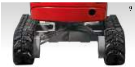
LARGEUR DU TRAIN DE ROULEMENT DÉPLOYÉ 1 020 MM
