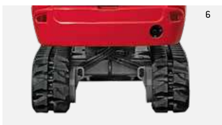
LARGEUR DU TRAIN DE ROULEMENT RÉTRACTÉ 980 MM
