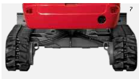
LARGEUR DU TRAIN DE ROULEMENT DÉPLOYÉ 1.300 MM
