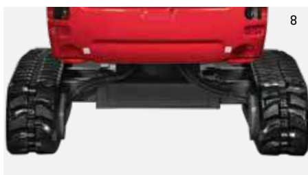
LARGEUR DU TRAIN DE ROULEMENT DÉPLOYÉ 1500 MM
