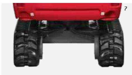
LARGEUR DU TRAIN DE ROULEMENT RÉTRACTÉ 1100 MM
