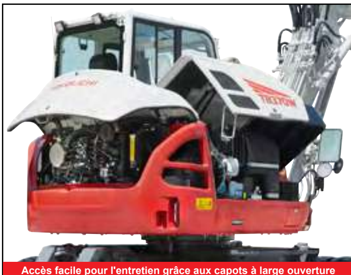
Cabine basculante offrant une excellente accessibilité pour l'entretien
