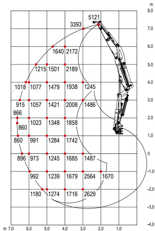
Les charges de levage indiquées dans les graphiques représentent respectivement jusqu'à 87 % de la charge de levage hydraulique et jusqu'à 75 % de la charge de basculement. Les valeurs sont mentionnées en kilogrammes. Sous réserve de modifications techniques.
