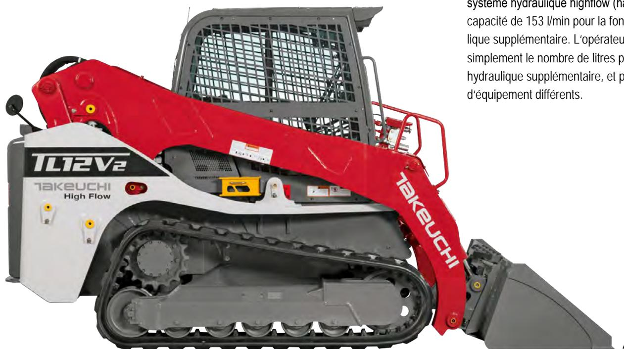
La chargeuse TL12 V2 est équipée de série d'un système hydraulique highflow (haut débit), d'une capacité de 153 l/min pour la fonction hydraulique supplémentaire. L'opérateur peut régler simplement le nombre de litres pour la fonction hydraulique supplémentaire, et pour trois pièces d'équipement différents.
